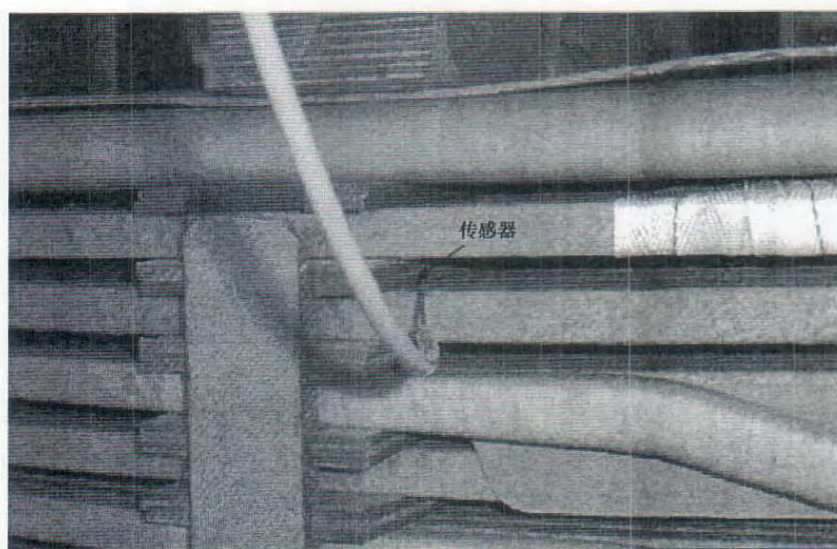
图 E.1 光纤传感器在心式变压器饼式绕组上的应用
